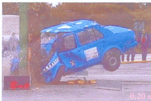
Obr. 5 Excentrický náraz na strom levou stranou přídě VW Jetta rychlostí 81 km/h
