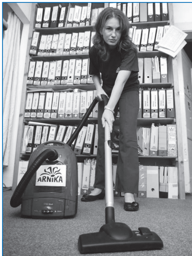
Odběr vzorků prachu nejvíce ze všeho připomíná klasické „luxování“. Vysavač je vyroben z materiálů, které neobsahují žádné z testovaných látek.
