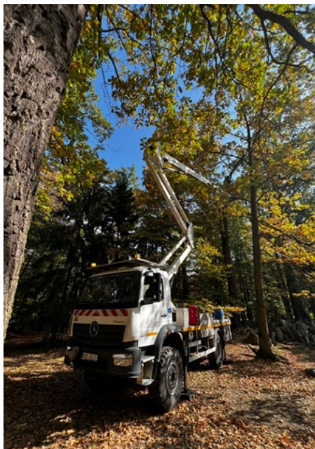
Vozidlo MB ATEGO GSR E 290PX s nástavbou pracovní plošiny. Fotoarchiv CZ-SK SOUTH LIFE (2022)
