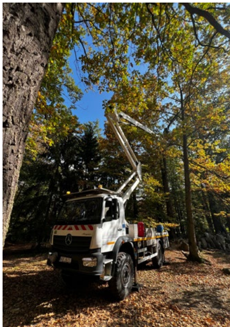
Pojazd MB ATEGO GSR E 290PX z nadbudową platformy roboczej. Foto: archiwum CZ-SK SOUTH LIFE (2022)
