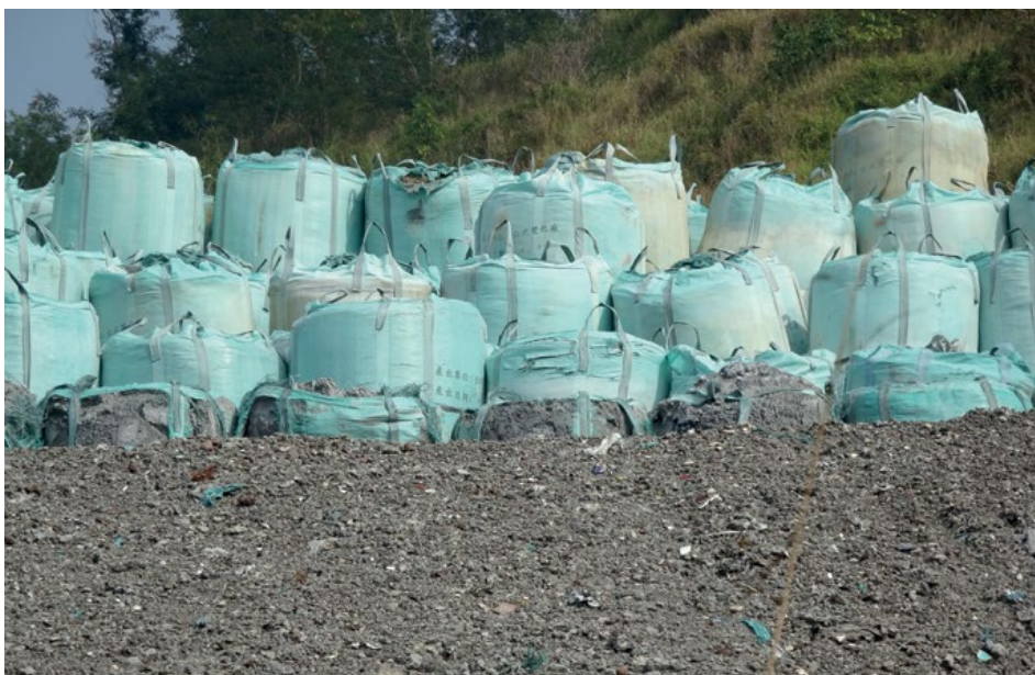
Foto 3.19 Takto vypadají solidifikované popílký (smíchané s cementem) na lokalitě Yan Chao na Tchajwanu (Bell et al., 2023).
