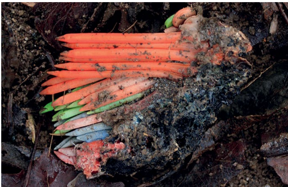
Foto 4.4: Materiál ze spalovny odpadů (SPRUK) obsahuje nespálený plastový odpad. Foto: Jindřich Petrlík, Arnika.
