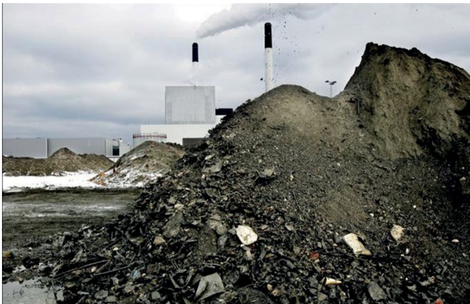
Foto 3.10: Popel a struska po spálení komunálních odpadů v kodaňské spalovně. Foto: Erik Refner (information.dk)
