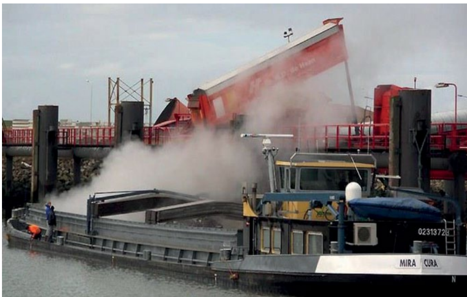
Foto 5.2 Dioxiny se mohou šířit i prostřednictvím fugitivních emisí, například při nakládání zbytků po spalování odpadů, jak to zachycuje tento snímek z nizozemského Harlingenu anebo foto 4.6 ze spalovny nebezpečných odpadů v Jihlavě kde je znatelný únik prachu při nakládání popílku. Foto: ToxicoWatch, zdroj: (Arkenbout & Bouman, 2018).
