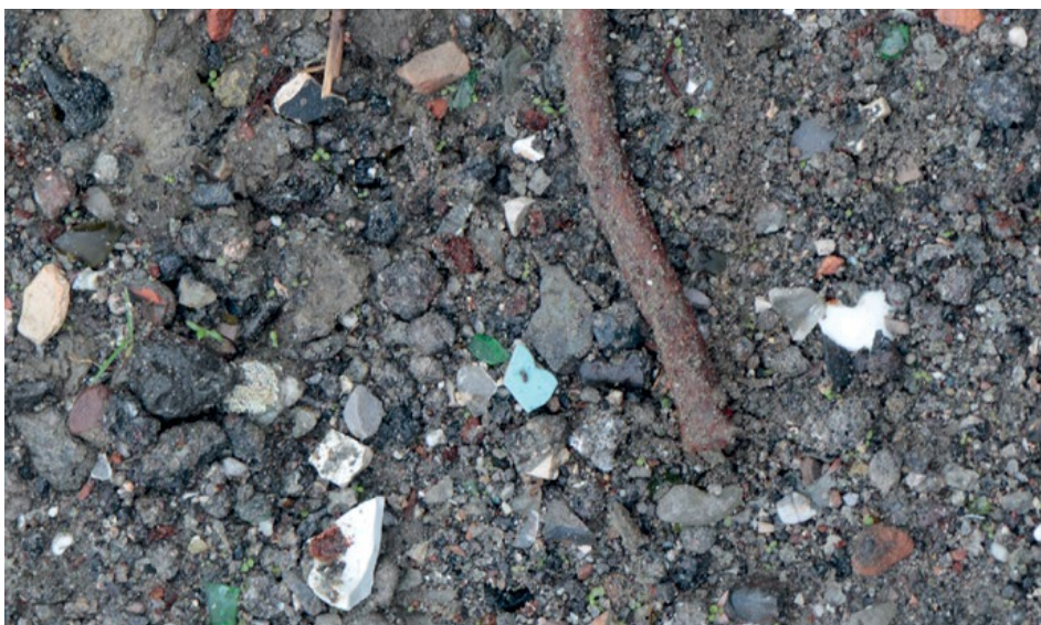
Foto 3.26 Že jde o popel ze spalování odpadů, je patrné z přítomnosti různých nedopálených zbytků kovových, skleněných anebo dokonce plastových odpadů. Foto: Jindřich Petrlík, Arnika.
