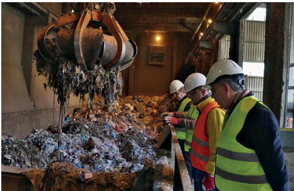
Foto 2.3: Firma EcoWaste u prachovické cementárny připravuje odpad pro spalování v cementárně: stačí nadrtit a odpad putuje do cementárny. Tento postup Eko-kom dlouhá léta vykazuje jako recyklaci plastů (Černý, 2021). Foto: Pardubický kraj.
