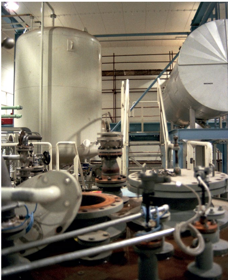
Foto 3.18 Reaktor pro zásaditý katalytický rozklad (BCD), jak byl použit ve Spolaně Neratovice k rozkladu dioxinů a organochlorových pesticidů. Foto: Jindřich Petrlík, Arnika.
