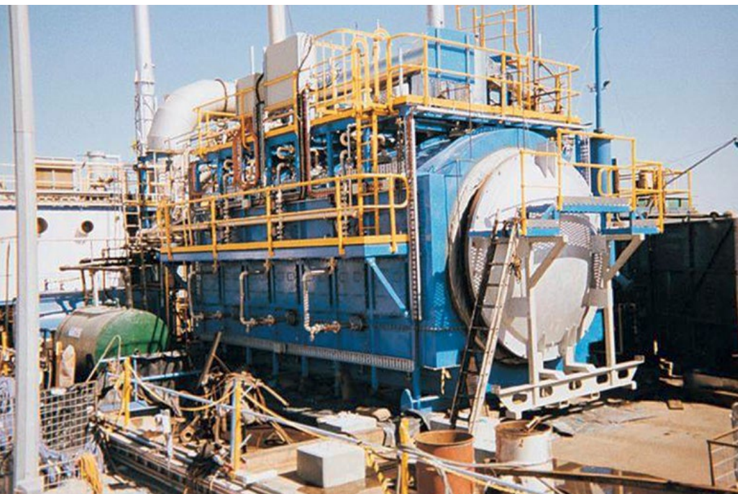
Foto 3.17: Technologie chemické redukce v plynné fázi (GPCR), jak byla použita v Austrálii. Zdroj: (Arnold, 2003)
