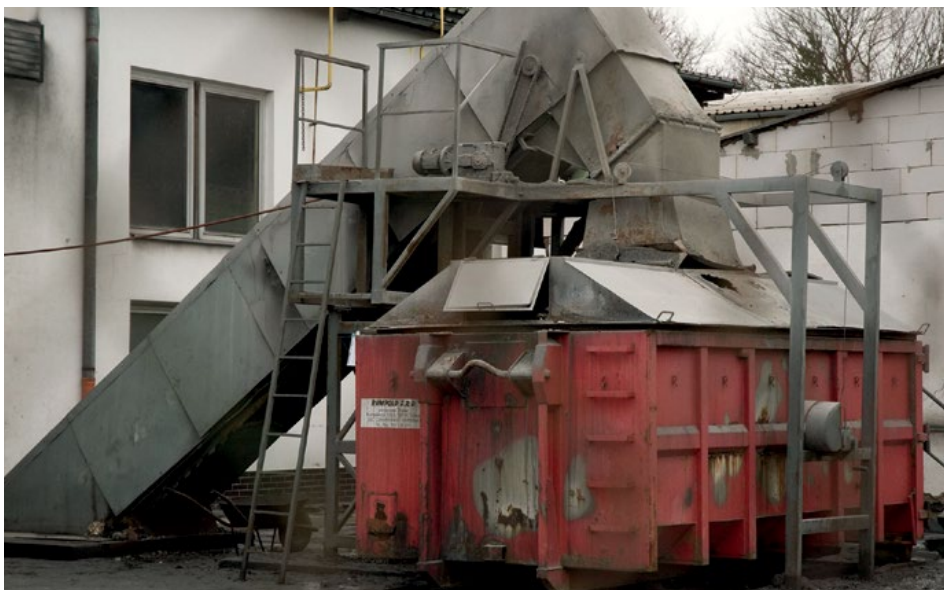
Foto 4.6 Popílků ze spaloven jsou velkým zdrojem dioxinů a vymykají se kontrole kvůli benevolentnímu limitu. Zařízení na shromažďování a převoz popílků ze spalovny nebezpečných odpadů v Jihlavě, jak vypadalo v roce 2012. Foto: Matěj Man, Arnika.
