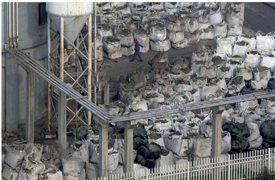
Foto 3.2: Popílek skladovaný na dvoře spalovny komunálních odpadů ve Wuhanu v Číně – pravděpodobný zdroj fugitivních emisí dioxinů. Zdroj: (Zhang et al., 2015)
