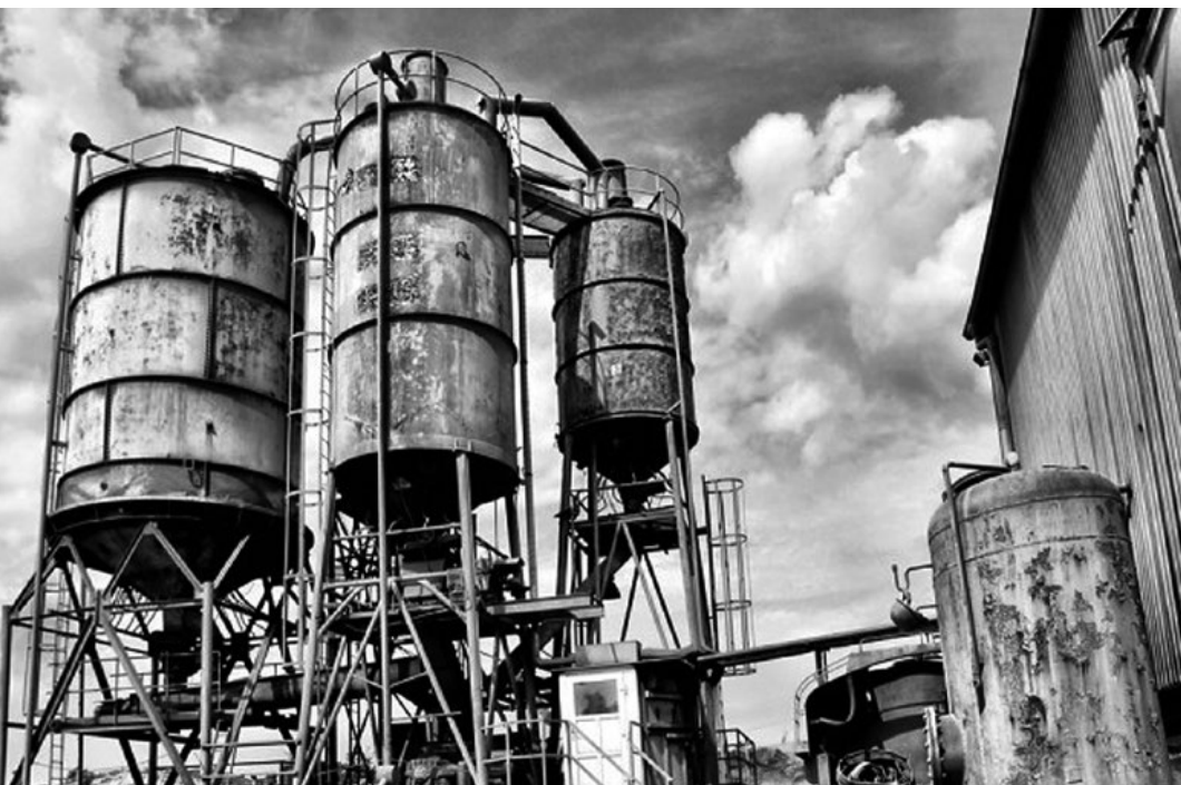
Foto 3.29 V Hůrce u Temelína se mimo jiné zpracovávají i popílky ze spaloven odpadů. Foto: mail.oakrupkovo.cz.
