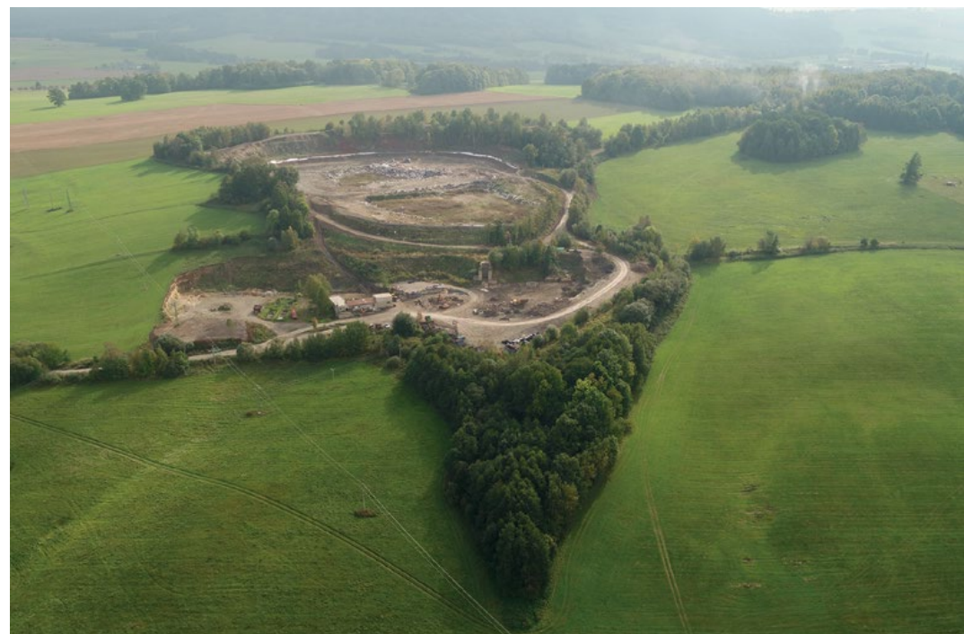
Foto 5.3 Při použití směsi popílku a popela ze spaloven odpadů pro povrchové úpravy skládek tak, jako na skládce Větrov u Frýdlantu (používá se směs z liberecké spalovny odpadů), je třeba vzít v potaz specifické podmínky pro vymýváním dioxinů. Foto z dronu pořízené v roce 2021: Marek Jehlička (skyworker.cz).
