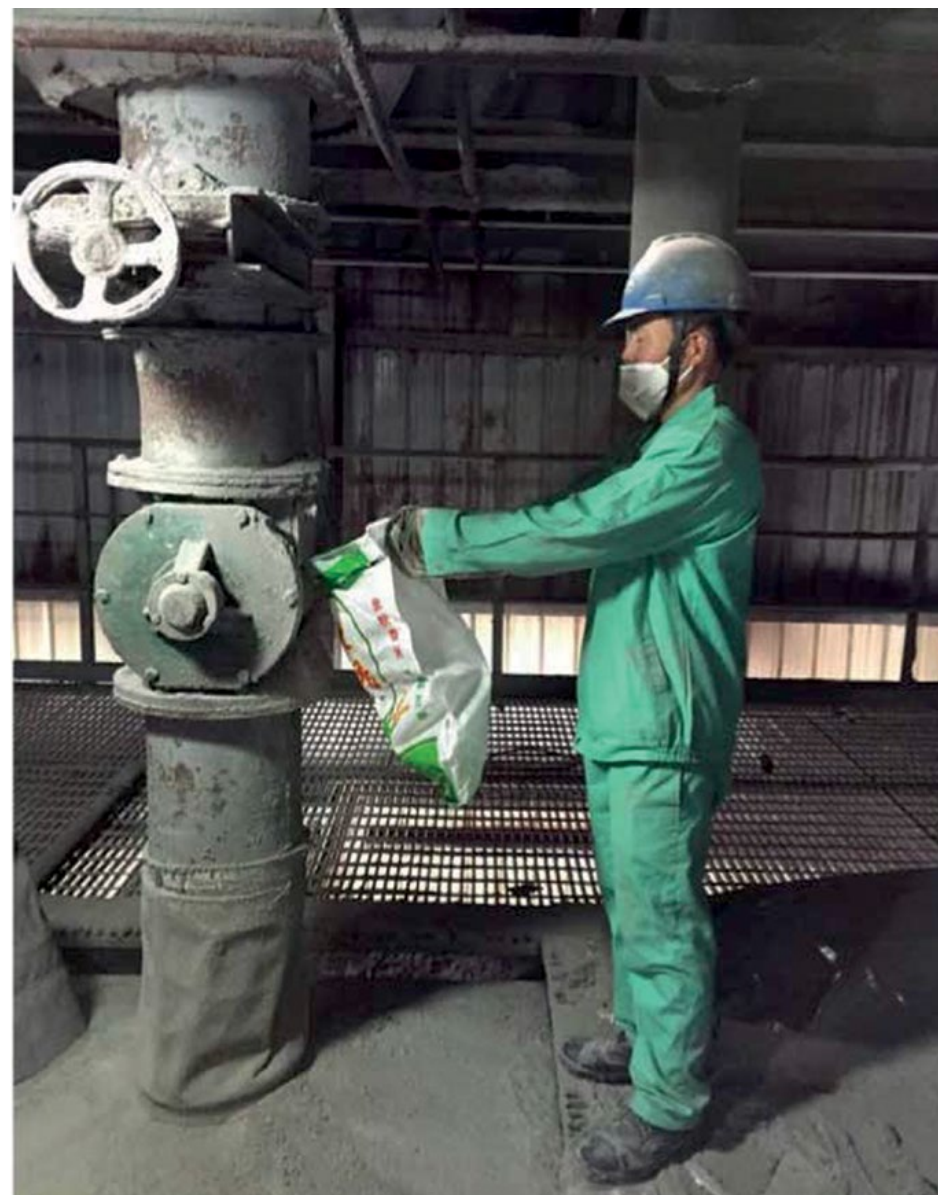
Foto 3.6: Odběr vzorku popílku jako produktu čištění spalin v čínské spalovně. Zdroj: (Tang et al., 2016)
