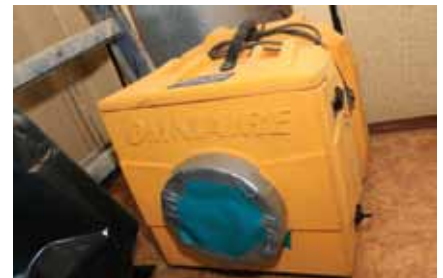
Během prací se využívají výkonné „pračky vzduchu“.
