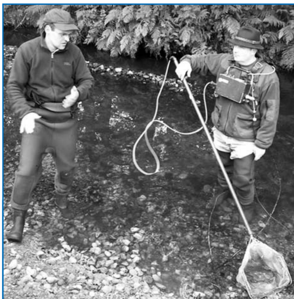
Rybáři pomocí agregátu se slabým elektrickým proudem ověřují stav rybí populace. Foto: Kateřina Kolaříková
