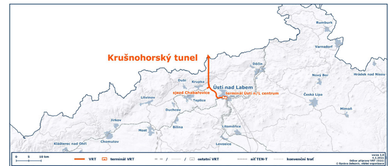
Krušnohorský tunel je pojmenování pro úsek nového železničního spojení Drážďany - Praha vedoucí z Heidenau do Ústí nad Labem. Zdroj: Správa železnic
