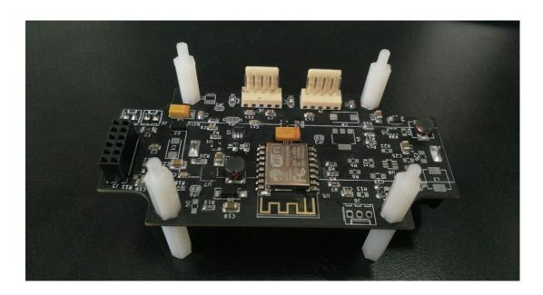
Плата контроллера содержит схемы питания и управления периферией, на ней находятся разъемы для подключения внешних устройств и плат расширения.
